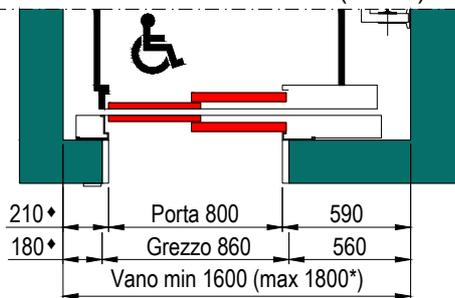
**SEZIONE VANO CORSA**
